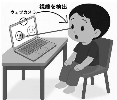
図 4. ウェブカメラを用いた視線検出の実験設定
